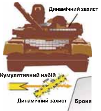
Розміщення та функції динамічного захисту
